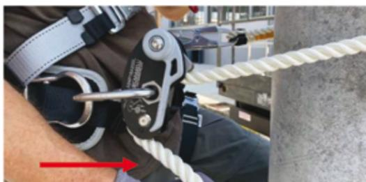
Il regolatore automatico consente all'operatore di effettuare la regolazione con un'azione continua impiegando una sola mano
