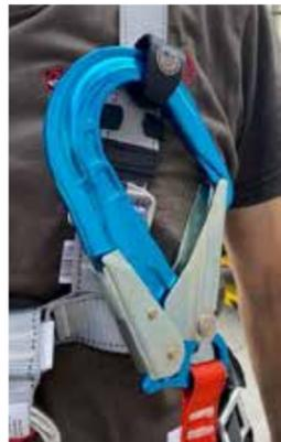
Due inserti applicati sulle bretelle per il posizionamento dei connettori dei cordini quando non in uso
