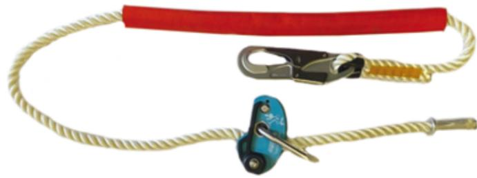
Fune in fibra poliammidica dia. 16 mm., lunghezza 2 m., con connettore in lega di alluminio a doppia sicurezza – Regolatore automatico di lunghezza e manicotto di protezione per uso su spigoli vivi. – Peso: 1,1 kg
