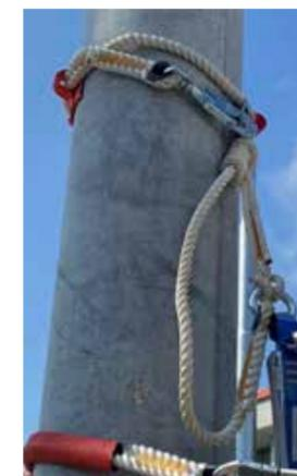
Il nodo prusik consente di poter regolare e posizionare il dispositivo in funzione del Ø del palo
