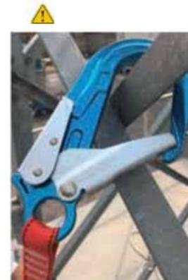
Nelle attività di scalata tralicci, sovente capita che il connettore vada a posizionarsi non sul suo asse longitudinale causando un pericoloso effetto leva sugli elementi di chiusura. Il connettore qui illustrato, è particolarmente consigliato per questa specifica attività poiché i suoi elementi di chiusura sono stati rinforzati in conformità alle norme CSA e ANSI garantendo connessioni, su strutture tralicciate, anche con involontari posizionamenti a leva sul suo asse maggiore
