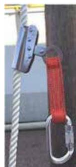
corsore anticaduta **EN 353-2** realizzato in acciaio inox corredato di prolunga di 21 cm con connettore per l'attacco al punto d'ancoraggio dorsale o sternale dell'imbracatura per il corpo di cui alla norma **EN361/358**
