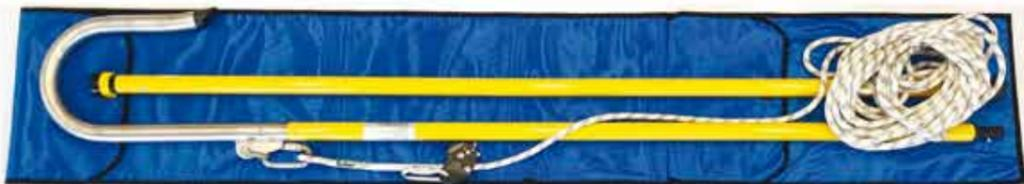
Il complesso anticaduta "Gancio Pastorale" è una tecnica di scalata in sicurezza su vecchi tralicci sprovvisti di scaletta laterale. Permette all'operatore l'attività di scalata in semi-continuità sollevando l'asta agganciandola ai nodi della struttura. L'operazione di sollevamento e aggancio dell'asta deve essere obbligatoriamente compiuta con l'ausilio del cordino di posizionamento EN358
