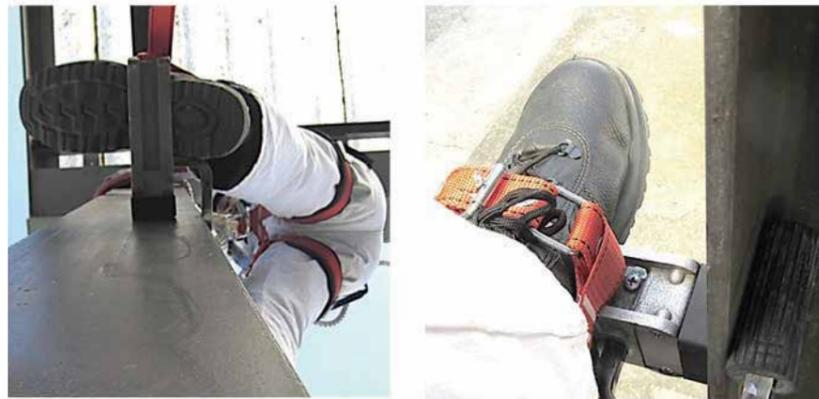
Когти-лазы предназначены для Н-образных тавровых структур толщиной от 5 до 20 мм. Литые подножные пластины из легкого алюминиевого сплава с полиэфирными ремнями и специализированным чугунным покрытием с противоскользящими резиновыми накладками. Вес пары: 2,7 кг
