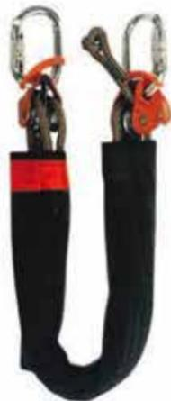
Полиспагт длиной 1 м с двумя блоками, один из которых с интегрированным запирающим устройством и тросом диаметром 8 мм. Позволяет поднимать пострадавшего со снижением скорости до 1/4 и держать в подвешенном состоянии до освобождения от страховочной системы.
