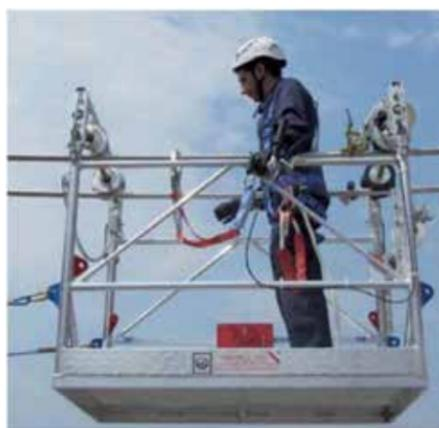
Carrozzini d'ispezione conduttori binati e trinati, realizzati in alluminio, tipo manuali o motorizzati. Trattasi di prodotti non di serie, sono realizzati su richiesta specifica del cliente.
